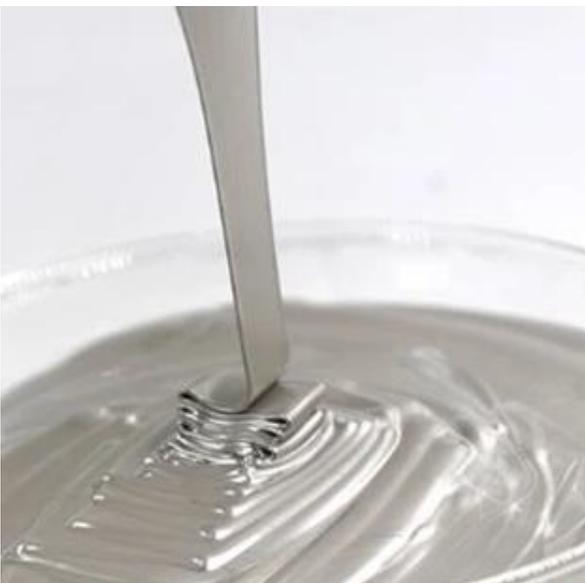
L'argento è il materiale che usiamo per la realizzazione dei circuiti elettrici, grazie alla sua elevata conducibilità termica ed elettrica e la ridotta ossidazione negli anni, abbiamo creato elementi stabili nel tempo.
